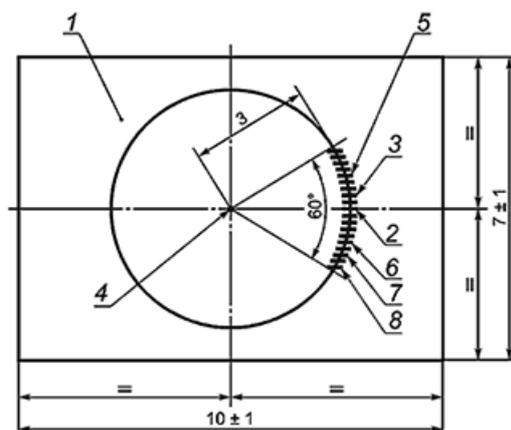
1 - помещение для проведения огневых испытаний; 2 - измеритель оптической плотности дыма (приемник/передатчик); 3 - устройство контроля температуры; 4 - место расположения тестового очага; 5 - измерительная зона точечных ИП (см. рисунок А.2); 6 - контрольно-ионизационная камера; 7 - газоанализатор; 8 - измеритель концентрации аэрозоля
