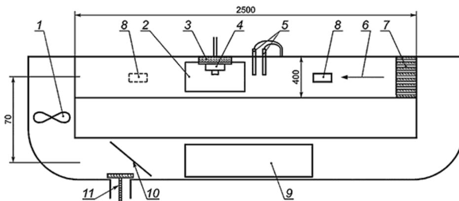
1 - вентилятор с двигателем; 2 - крышка отсека для установки испытуемого ИП со стеклянным смотровым окном; 3 - площадка с поворотным устройством для установки испытуемого ИП; 4 - испытуемый ИП; 5 - измерители температуры и скорости потока воздуха; 6 - направление потока воздуха; 7 - линеаризатор; 8 - устройство для измерения удельной оптической плотности (концентрации аэрозоля); 9 - отсек нагревателя; 10 - регулятор скорости потока воздуха; 11 - вентиляционное отверстие
