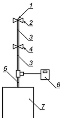
1 - открытый конец тестового трубопровода; 2 - вторичный регулируемый клапан; 3 - тестовый трубопровод длиной (1-2) м без воздухозаборных отверстий и дополнительных компонентов; 4 - первичный регулируемый клапан; 5 - отрезок тестового трубопровода длиной не менее 30 см; 6 - анемометр; 7 - испытуемый ИПДА
