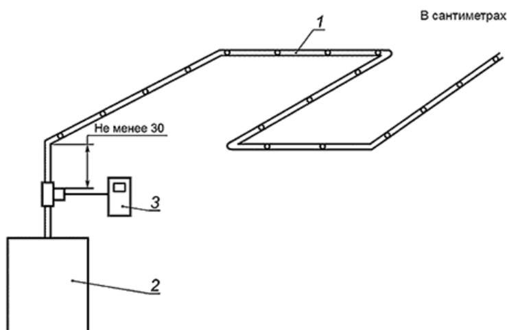
1 - воздушный трубопровод (с установленными в худшем сочетании для проведения огневых испытаний дополнительными компонентами); 2 - испытуемый ИПДА; 3 - анемометр
