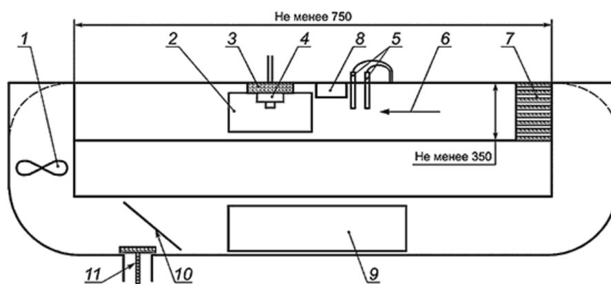
1 - вентилятор с двигателем; 2 - крышка отсека для установки испытуемого ИПДИ со стеклянным смотровым окном; 3 - площадка с поворотным устройством для установки испытуемого ИПДИ; 4 - испытуемый ИПДИ; 5 - измерители температуры и скорости потока воздуха; 6 - направление потока воздуха; 7
